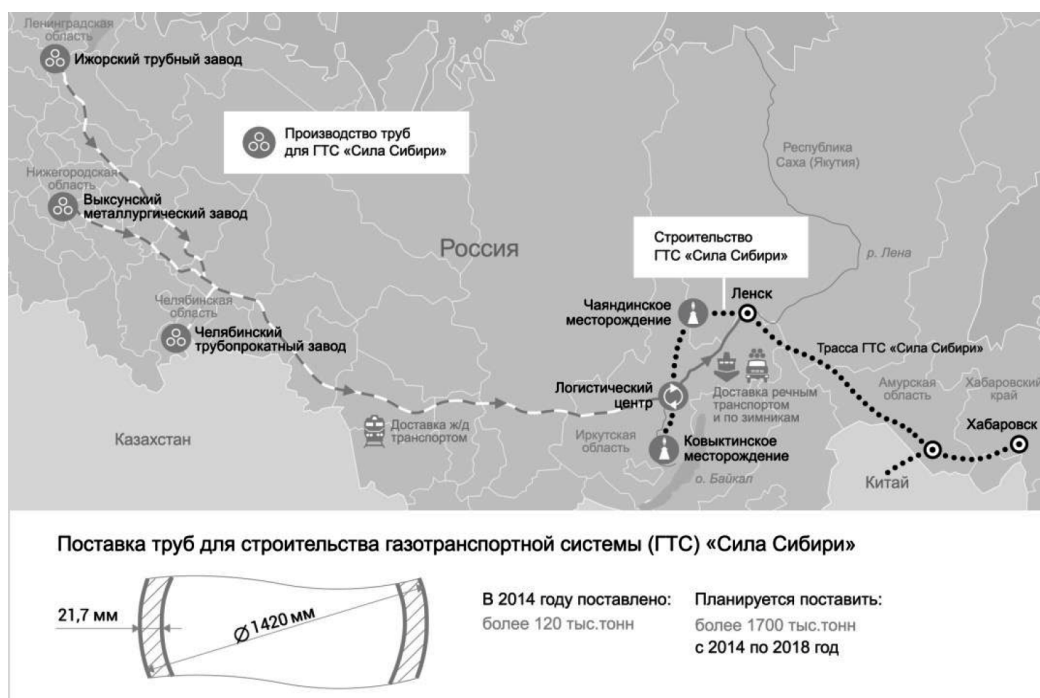
Рис. 2. Схема маршрута газопровода «Сила Сибири» («Восточный маршрут») [5]
